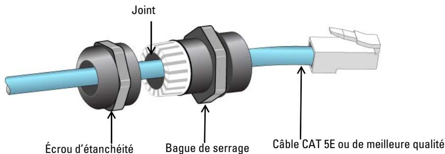
1. Faites glisser l'écrou d'étanchéité le long du câble (sans attacher le connecteur RJ45 à l'extrémité).
